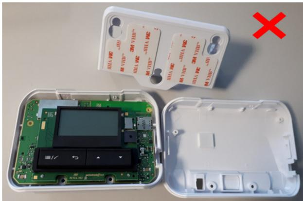
Bild 4 - Beispiel einer beschädigten OBU
