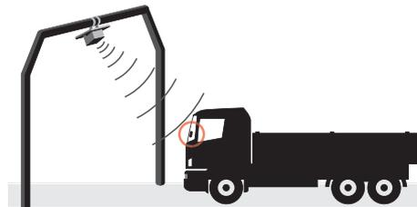
Auf Straßenabschnitten, auf denen das Funksystem zur Anwendung kommt, erfolgt die Erfassung mithilfe von Antennen, die auf den eigenen Mautspuren positioniert sind, bzw. – bei Verfügbarkeit des Free-Flow-Dienstes – auf Portalen, die sich entlang des Straßennetzes befinden. Beim Durchfahren der Portale wird die ordnungsgemäße Funktion des Geräts durch akustische Signale und/oder Displaymeldungen angezeigt.
