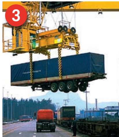
„Unbegleiteter Kombinierte Verkehr“: Hier wird der komplette Sattelaufleger ohne Zugmaschine auf besondere Taschenwagen verladen.
