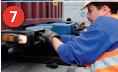
Container und Wechselbrücken werden bspw. mit genormten Verriegelungen (z. B. „Twist Locks“) am Trägerfahrzeug gesichert.
