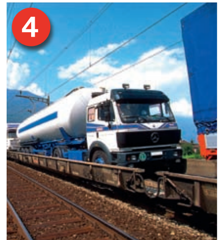
„Rollende Landstraße“: Komplett Straßenfahrzeuge fahren mit eigener Kraft auf spezielle Niederflurwagen der Eisenbahn auf.
