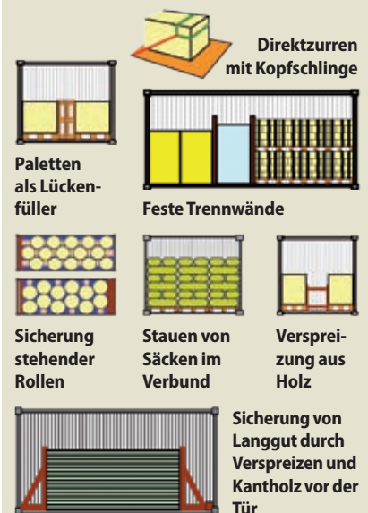
8 Beim Transport auf der Schiene gelten andere Beschleunigungsbeiwerte als auf der Straße. Dieser Umstand ist beim Verladen zu beachten.
