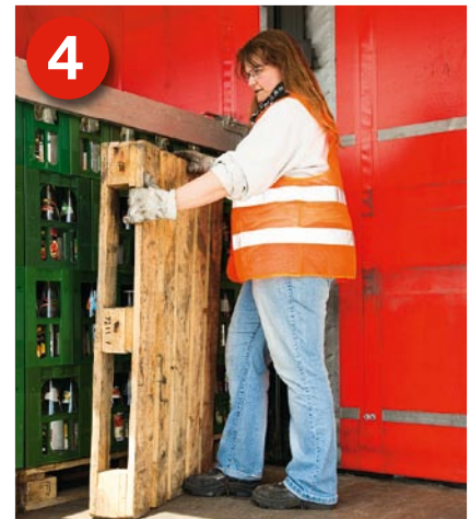
4 Sichern: Die Fahrerin stellt Leerpaletten senkrecht gegen die Getränkekästen, um diese vor den Fässern zu schützen.
