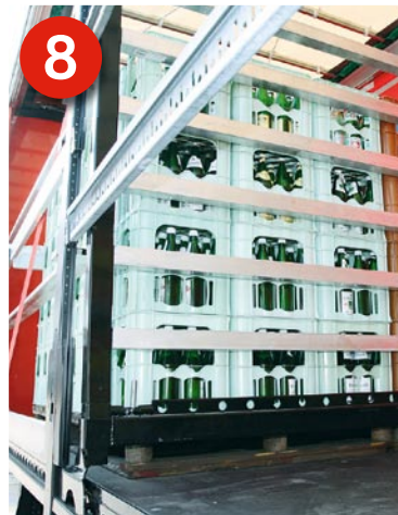
8 Weitere Lasi-Variante: Kipplatten sowie Sperrbalken, die mittels Lochschiene mit dem Fahrzeugaufbau verbunden sind.
